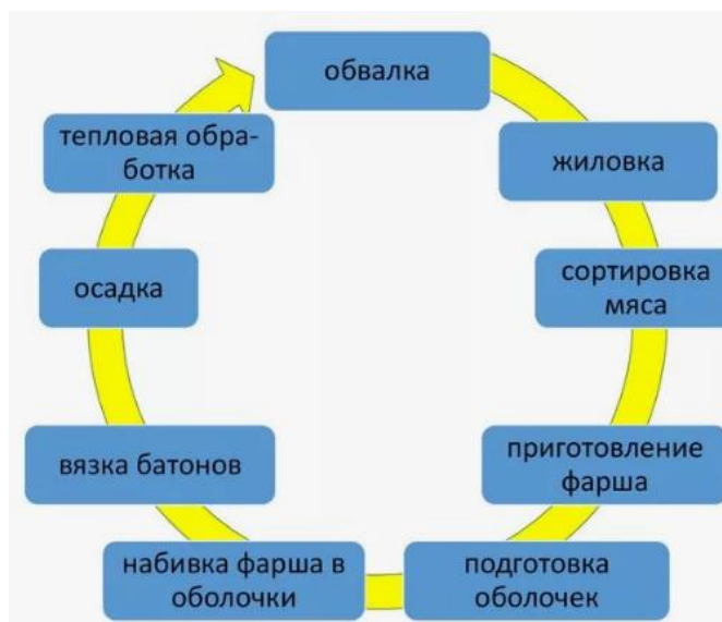
Рис. 1 Схема производства колбасных изделий
