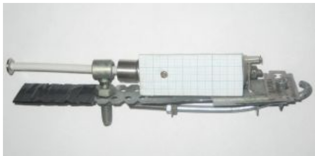
Рисунок 1 – Общий вид устройства для нанесения стандартизованной травмы сухожилия
