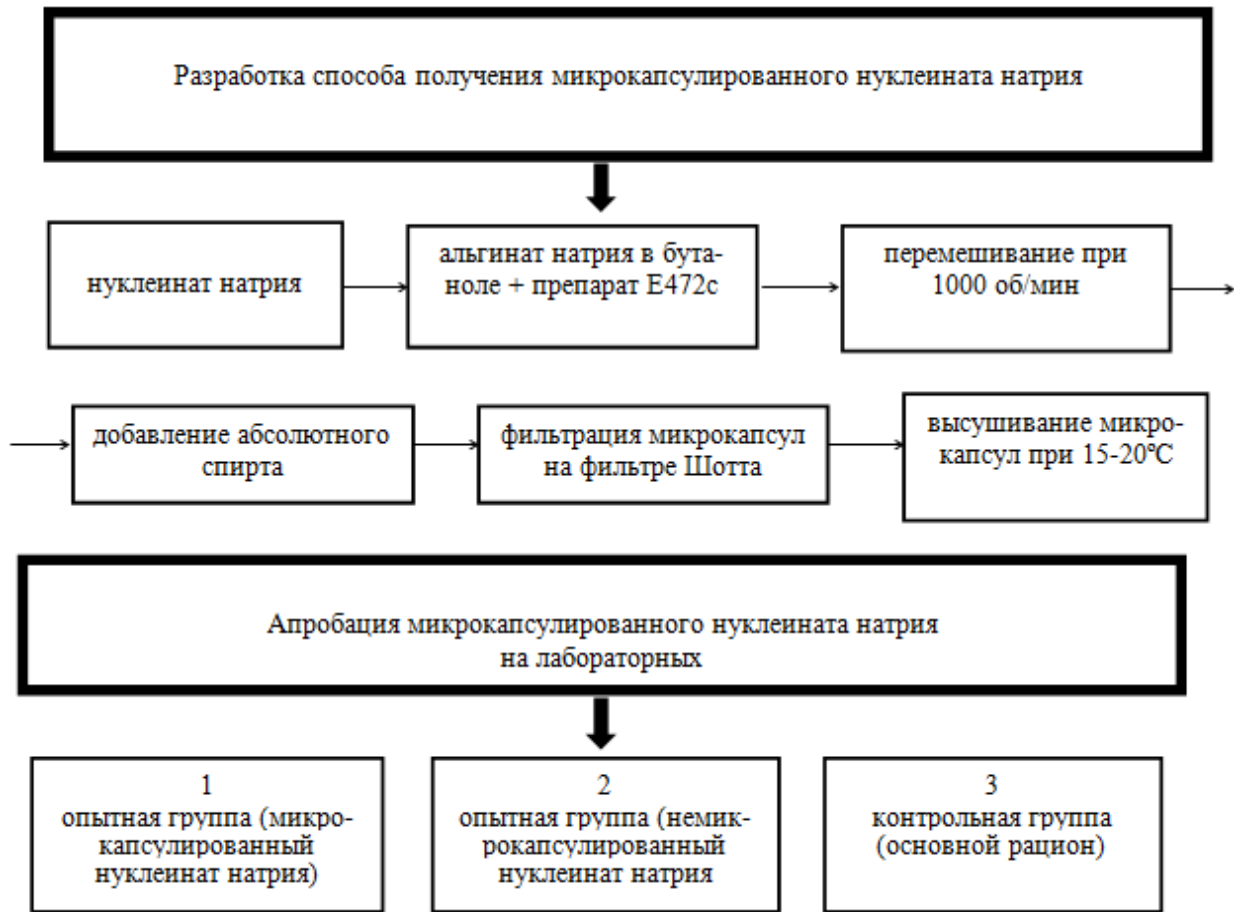
Рисунок 1 - Общая схема получения и апробации микрокапсулированного нуклеината натрия
