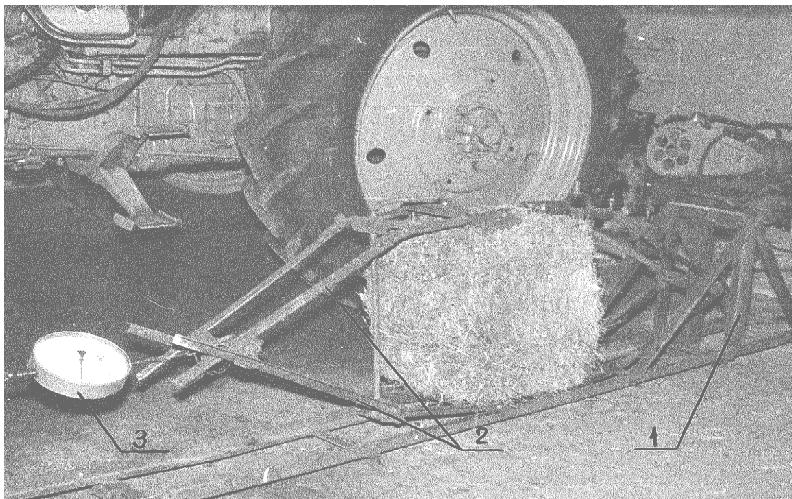
1 – рама; 2 – раздвижные захваты; 3 – стрелочный динамометр
