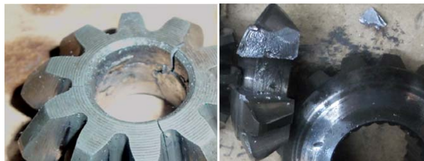
Рис. 2. Вид поверхностей трения шестерен дифференциала вследствие заедания (схватывания)
