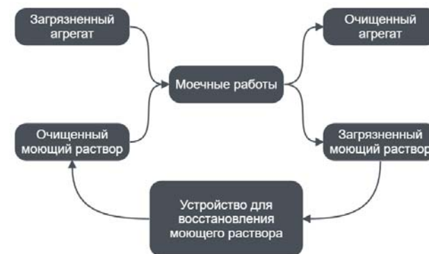
Рисунок 1 – Схема процесса мойки агрегатов и восстановления моющего раствора
