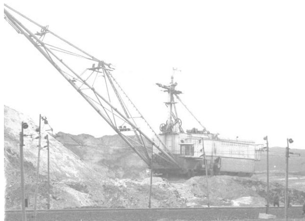
Рисунок 3 – Отсыпка горных пород в отвалы
