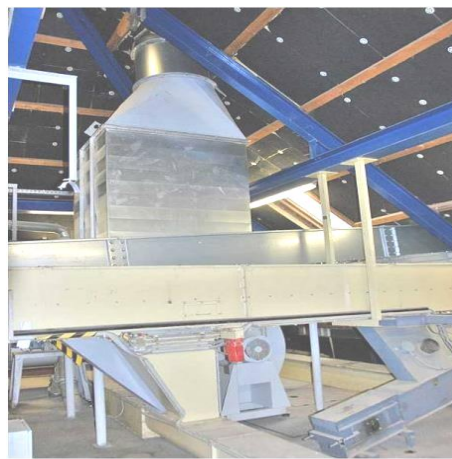
Рисунок 4 - Экстракционная установка в компании BAG oil mill operations GmbH и кондиционер на маслобойне BAG [5]
