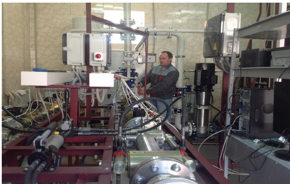
Рисунок 1 - Поверочная установка УПРМ-С Теплоком-100-0,05/0,1/0,25
