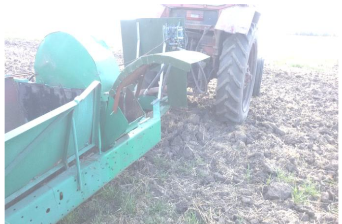
Рисунок 4 - Опытный образец телескопического дефлектора
