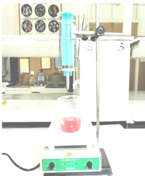
Рисунок 2 – Устройство для дозирования жидких веществ (обозначение по тексту) а – общий вид устройства; б – схема устройства
