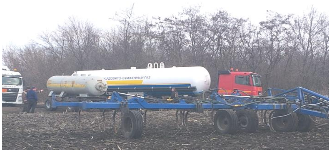
Рисунок 1 – Техника для внесения жидкого аммиака в почву
