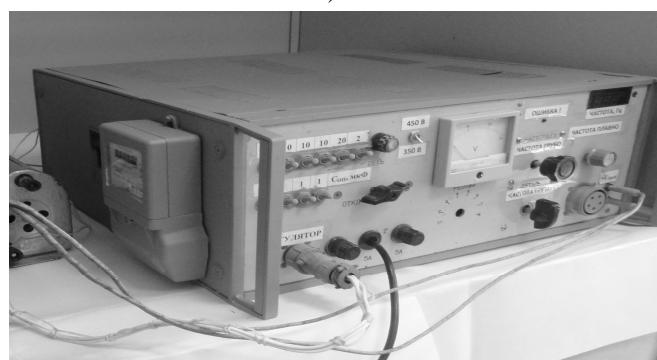
Рисунок 2 – Экспериментальная установка ЭЭД: а) структурная схема; б) генератор импульсов
