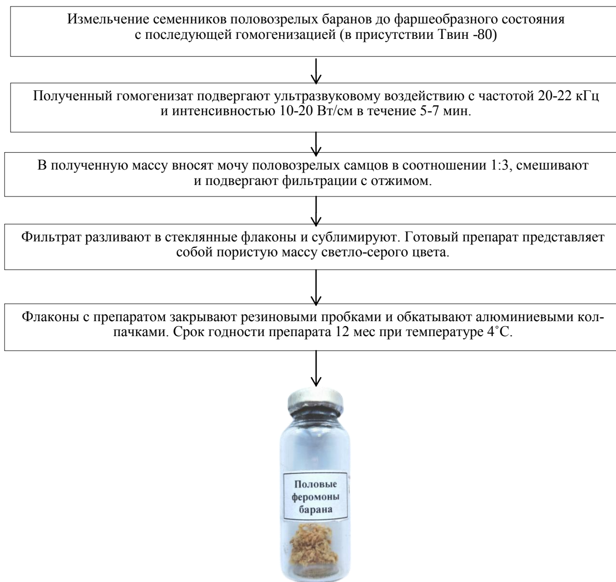
Рисунок 1 – Технологическая схема получения препарата натуральных половых феромонов барана
