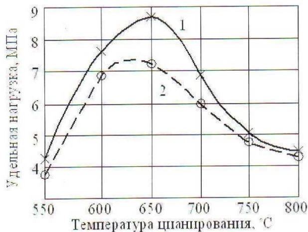
Рисунок 3 - Зависимости удельных нагрузок, при которых происходит схватывание цианированных поверхностей наплавов 30ХГСА (кривая 1) и СВ-08 (кривая 2) от температуры цианирования
