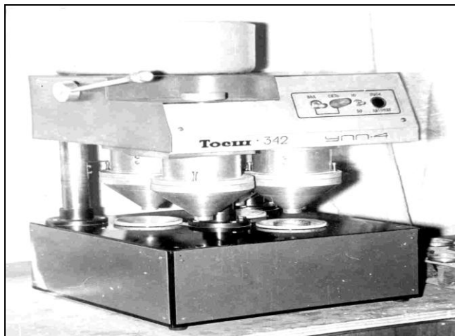
Рисунок 1 – Устройство УПП-4 для приготовления препаратов при промышленном микроанализе (опытный образец)
