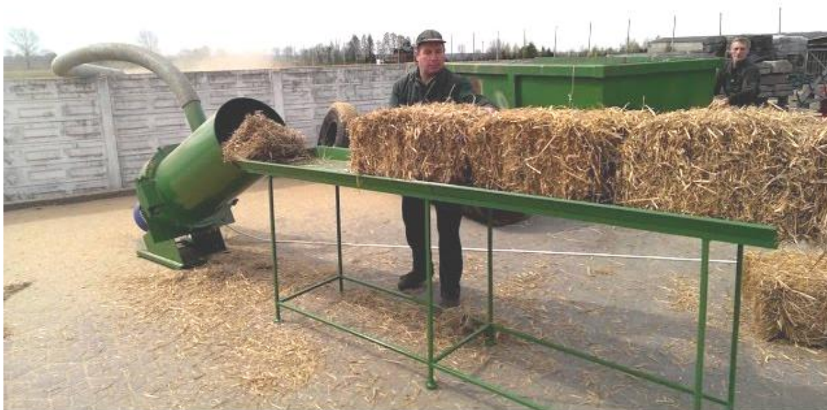
Рисунок 1 - Измельчитель грубых кормов марки Kuhn Primor 3570
