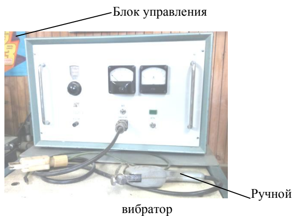
Рисунок 1а - Установка для электроискрового легирования «ЭФИ-45». Внешний вид
