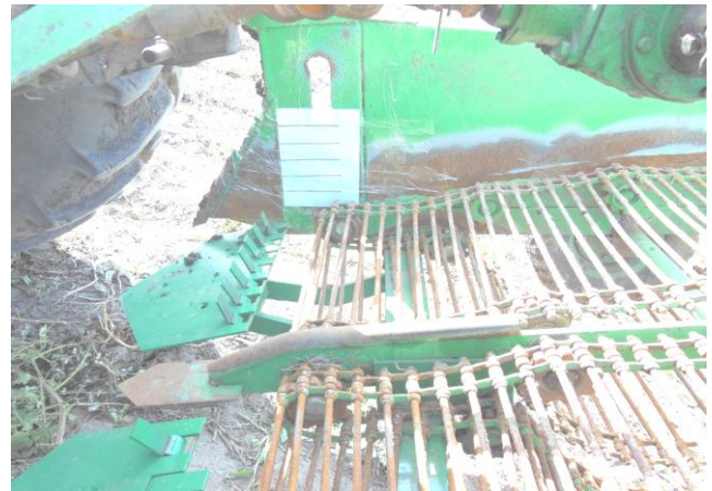
Рисунок 2 – Общий вид картофелекопателя с измерительной шкалой для фиксации высоты подскока компонентов
