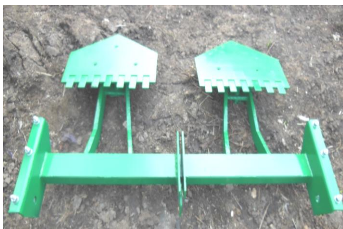
а) общий вид подкапывающего рабочего органа;
