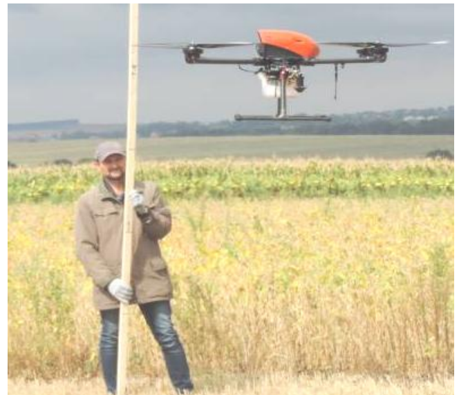
Рисунок 6 - Отработка приемов внесения с помощью БПЛА средств защиты растений
